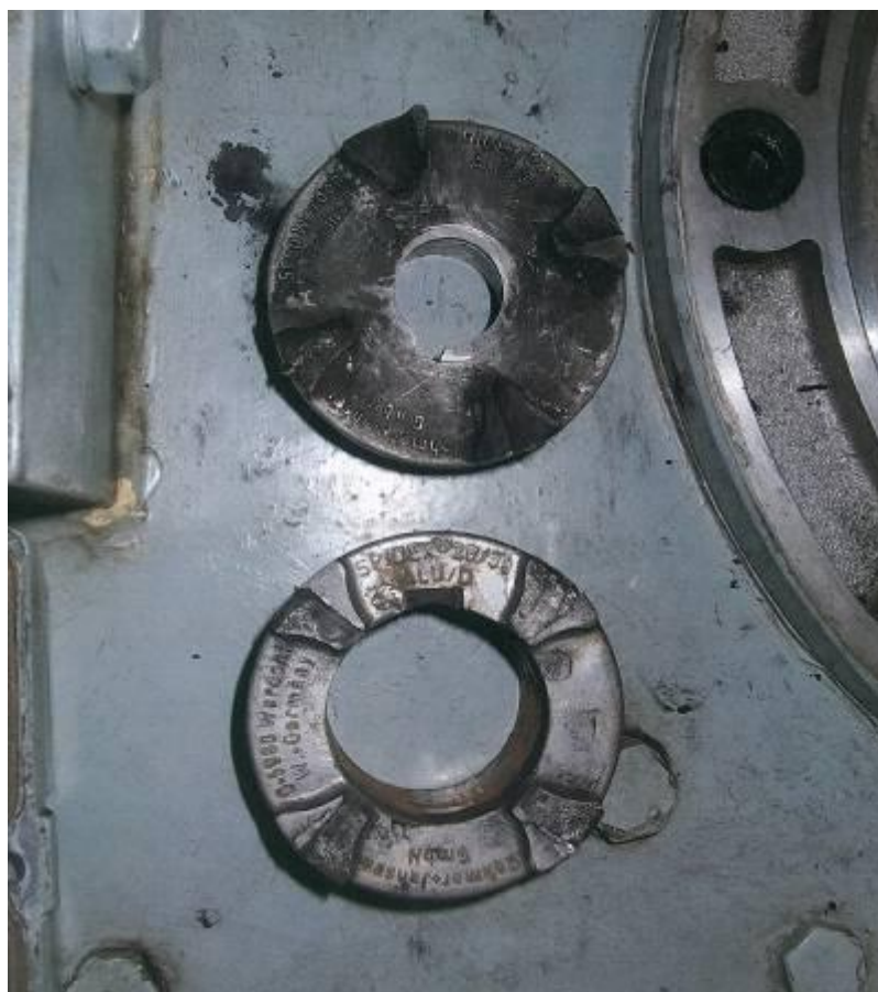
写真1 損耗したカップリング継手
