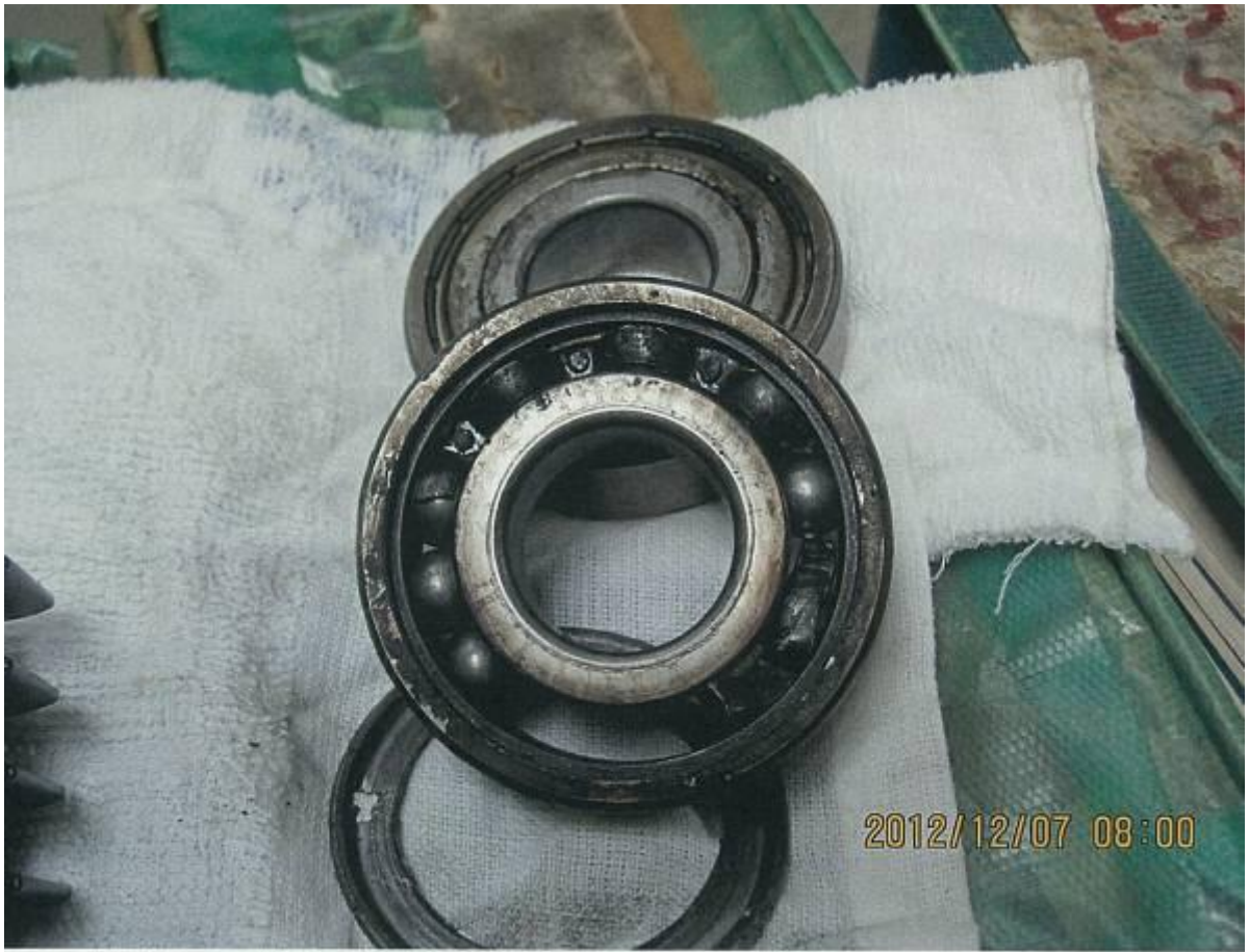
写真1 焼損した出力側軸受
