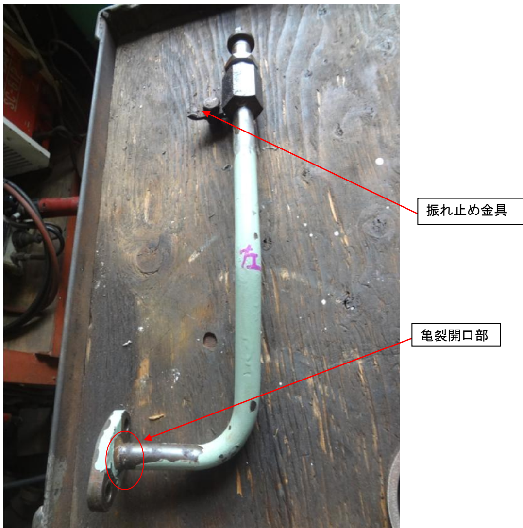
写真1 本件抜き出し管（修理前）
