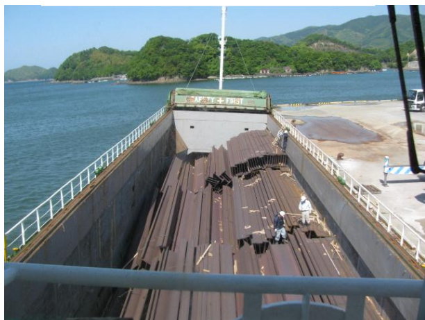
写真5 荷崩れ後の倉内の状況
