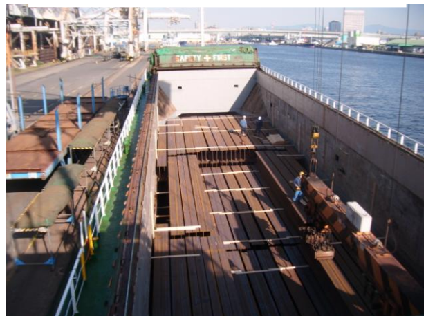
写真4 2段目、3段目の積付け状況②
