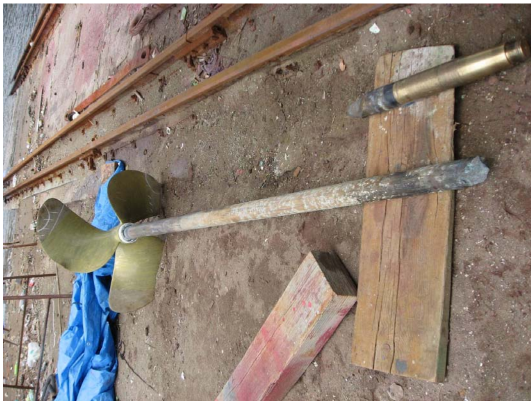
写真1 プロペラ軸の折損状況
