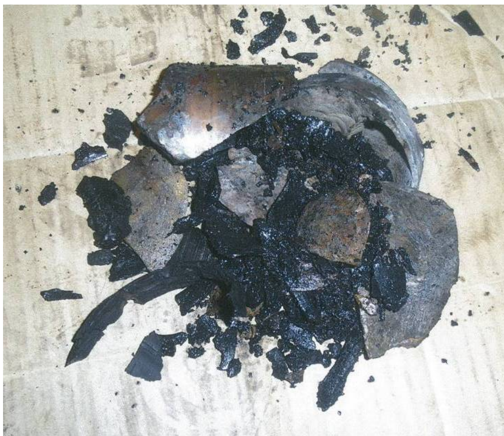
写真2 プロペラ軸の折損状況（破片部分）
