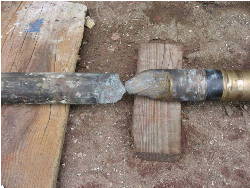
写真3 プロペラ軸の折損部の状況
