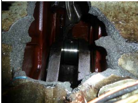
写真1 シリンダブロック損傷
