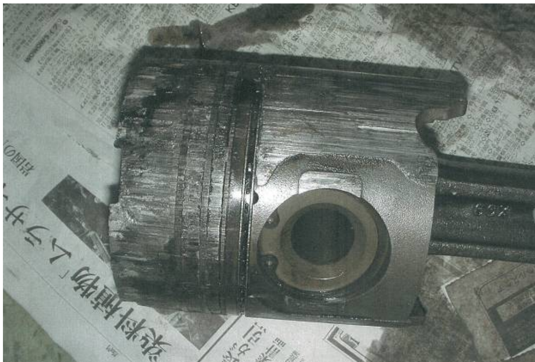
写真1 ピストンの損傷状況
