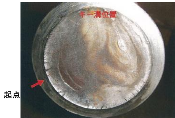
写真2 カム軸側破断面
