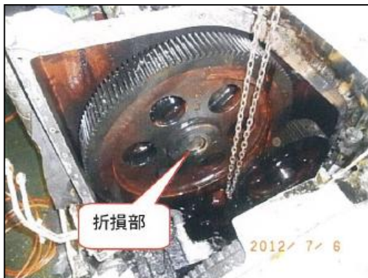
写真1 カム軸折損状況
