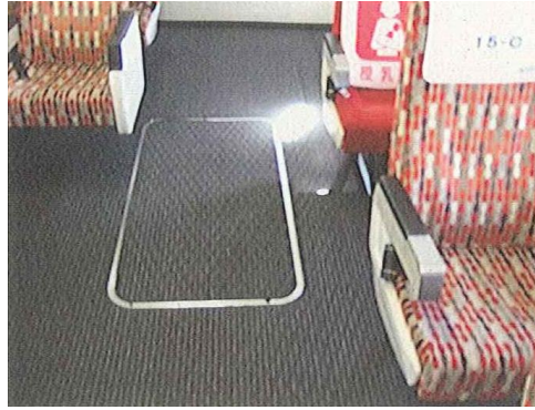
図 2-1 客室床のガスタービン室出入口
