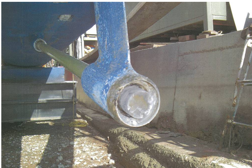
写真1 折損したプロペラ軸
