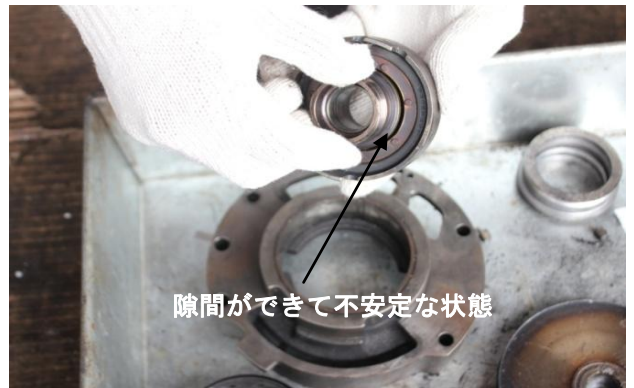
写真4 過給機のラビリンスブッシュの損傷状況
