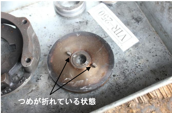
写真3 過給機の円盤ポンプの損傷状況
