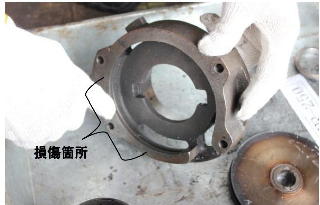
写真2 過給機のロータ軸軸受けの損傷状況
