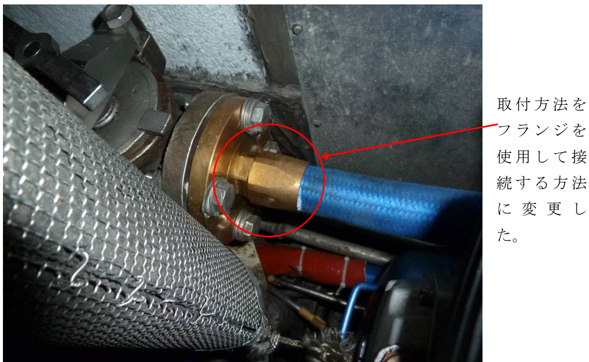
写真4 冷却海水ゴム管接続部分の変更後の写真
