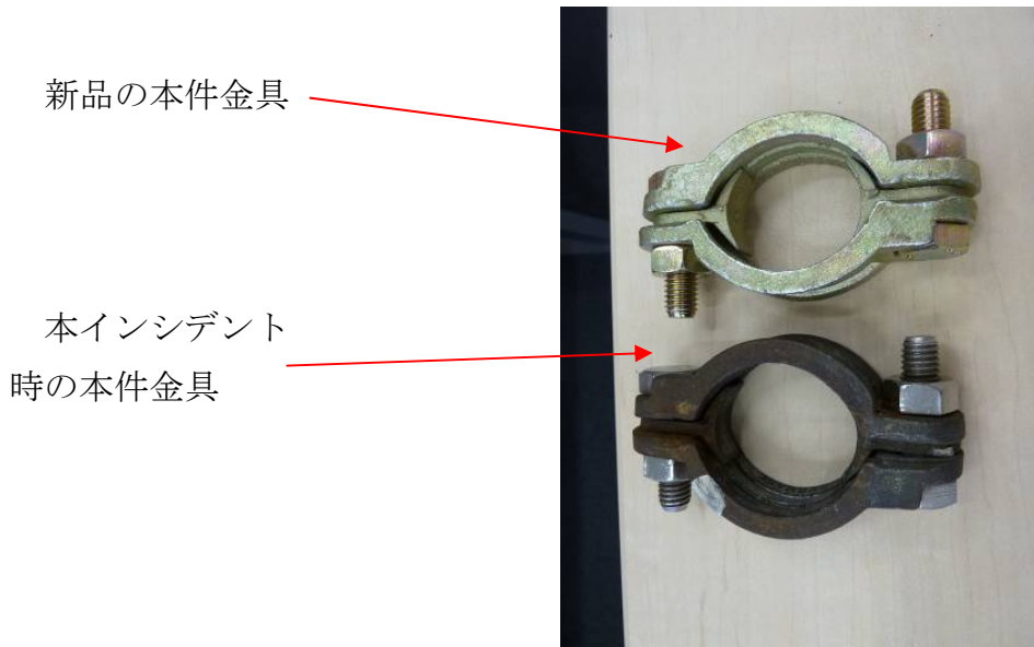
本インシデント時の本件金具と新品の本件金具との比較写真
