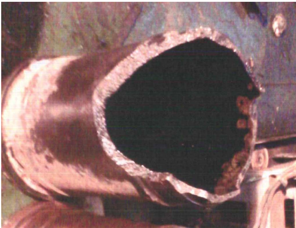
写真2 割損したシリンダライナ
