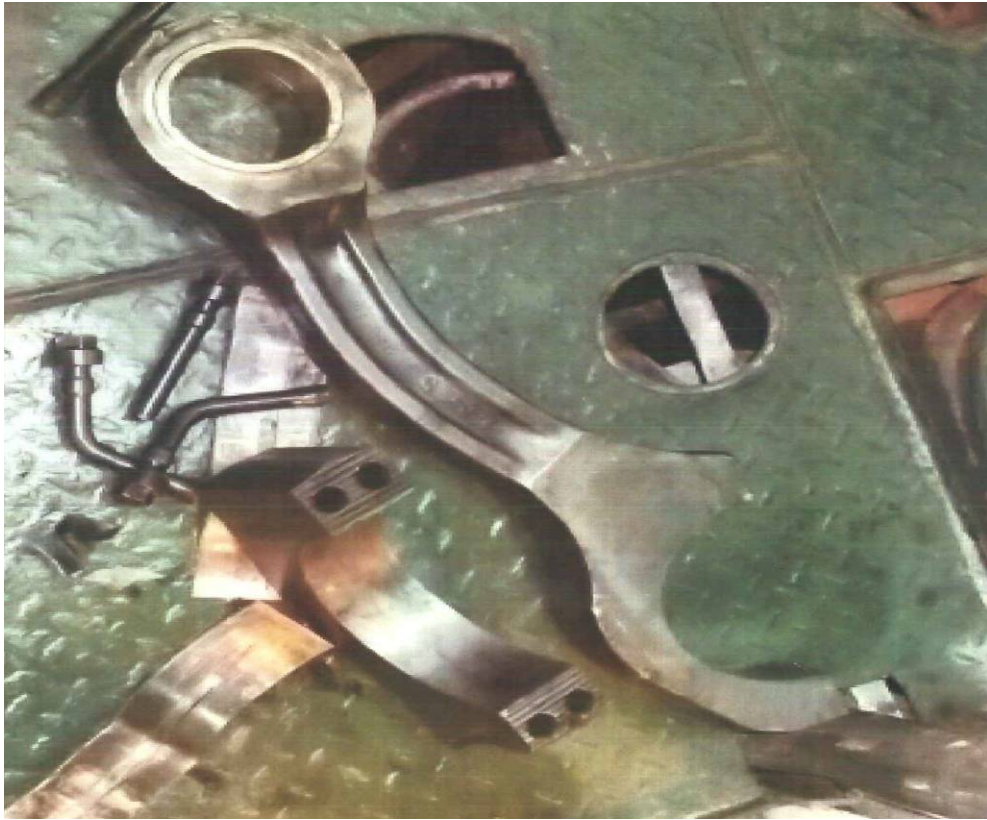
写真1 曲損した連接棒
