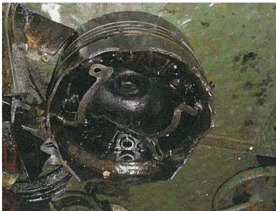
写真3 割損したピストン
