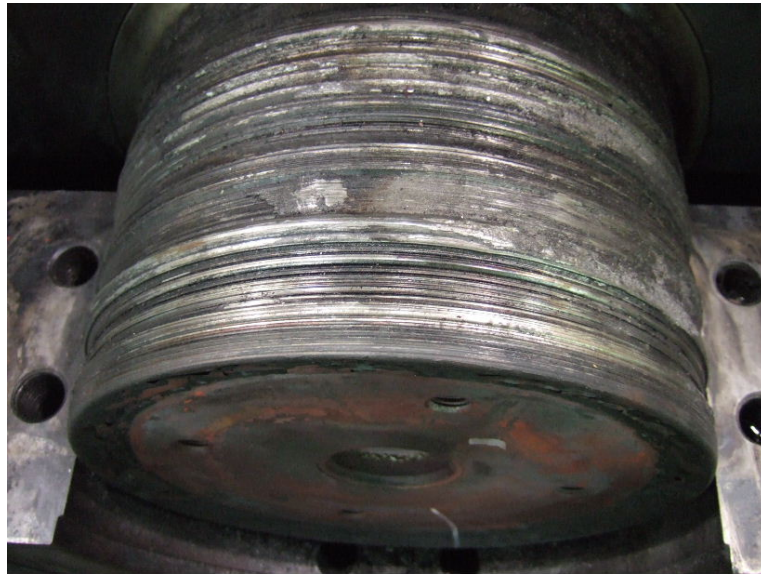
写真4 左舷減速機の出軸軸受摺動部損傷状況
