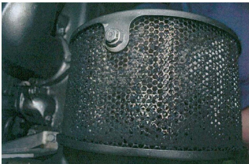
写真5 過給機焼損状況
