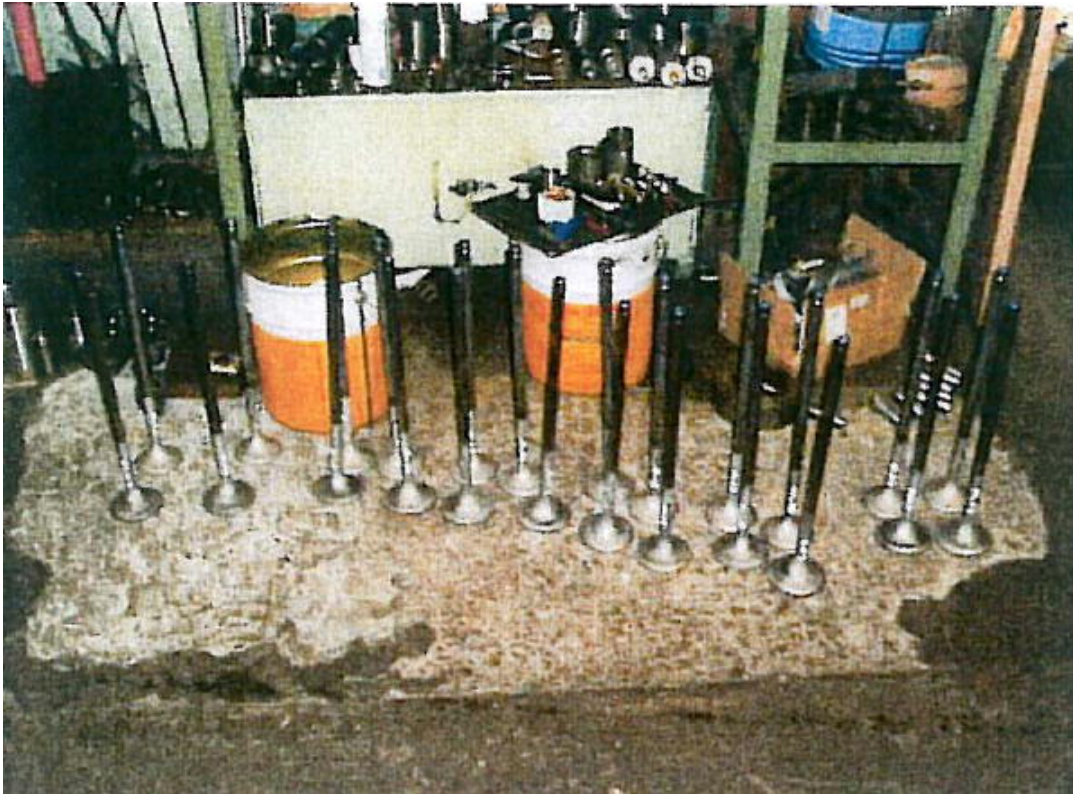
写真5 主機損傷状況 (吸・排気弁の弁棒曲損)
