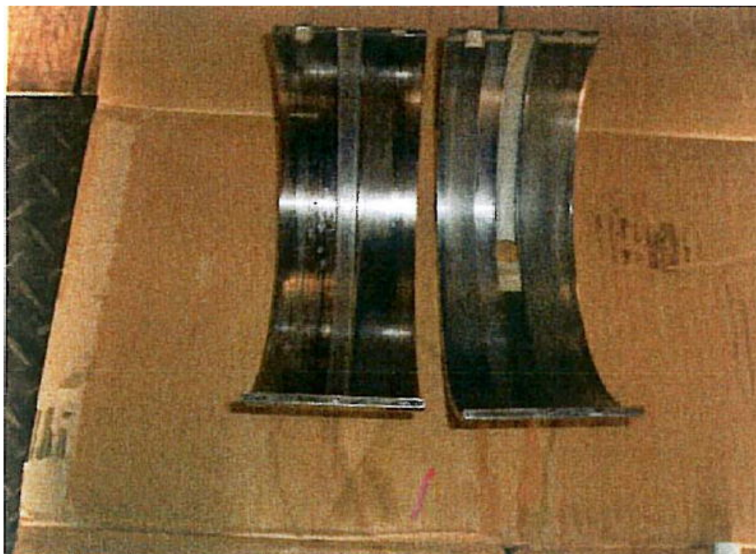
写真3 主機損傷状況 (1番クランクピン軸受メタル焼損)
