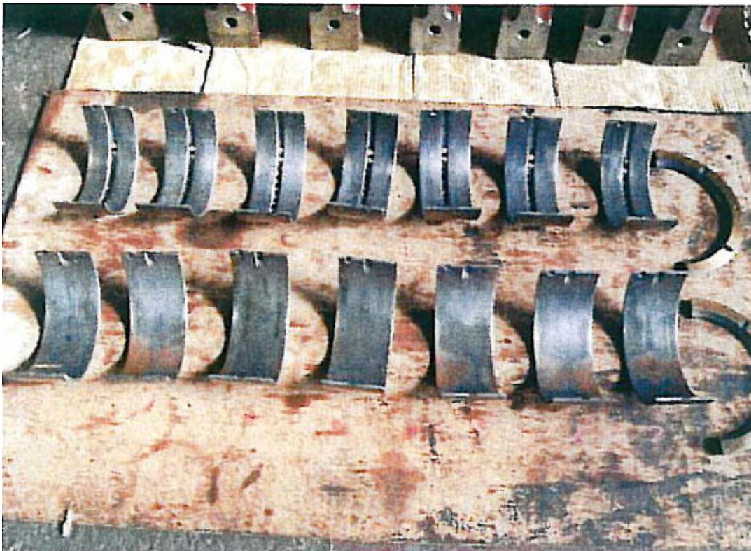
写真2 主機損傷状況（全主軸受メタル摩耗等）
