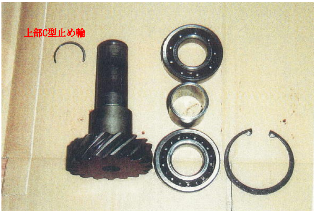
写真6 主機損傷状況 (ガバナ駆動装置)
