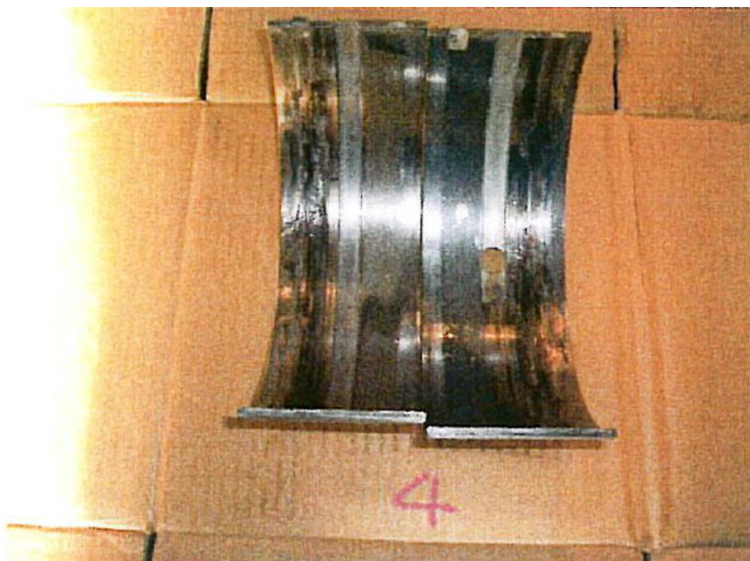
写真4 主機損傷状況 (4番クランクピン軸受メタル焼損)
