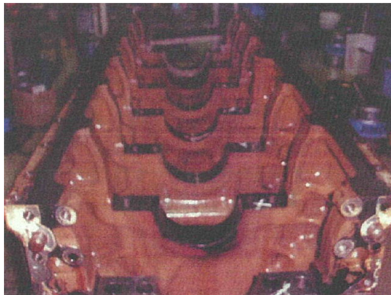
写真10 主機の損傷状況（クランクケース）
