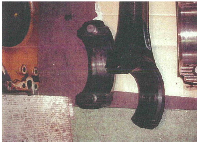
写真6 主機の損傷状況（6番シリンダ接続棒）
