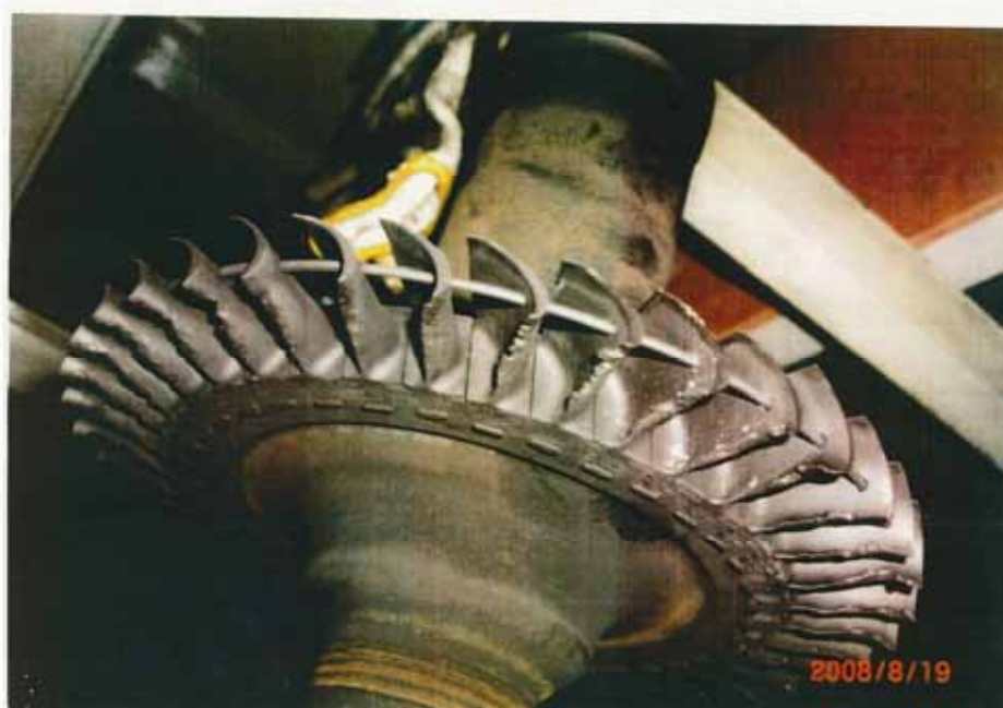
写真2 タービンブレードの損傷状況
