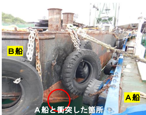
写真1 A船の左舷船首部及び船尾部にB船の係船索をそれぞれ取った状態
