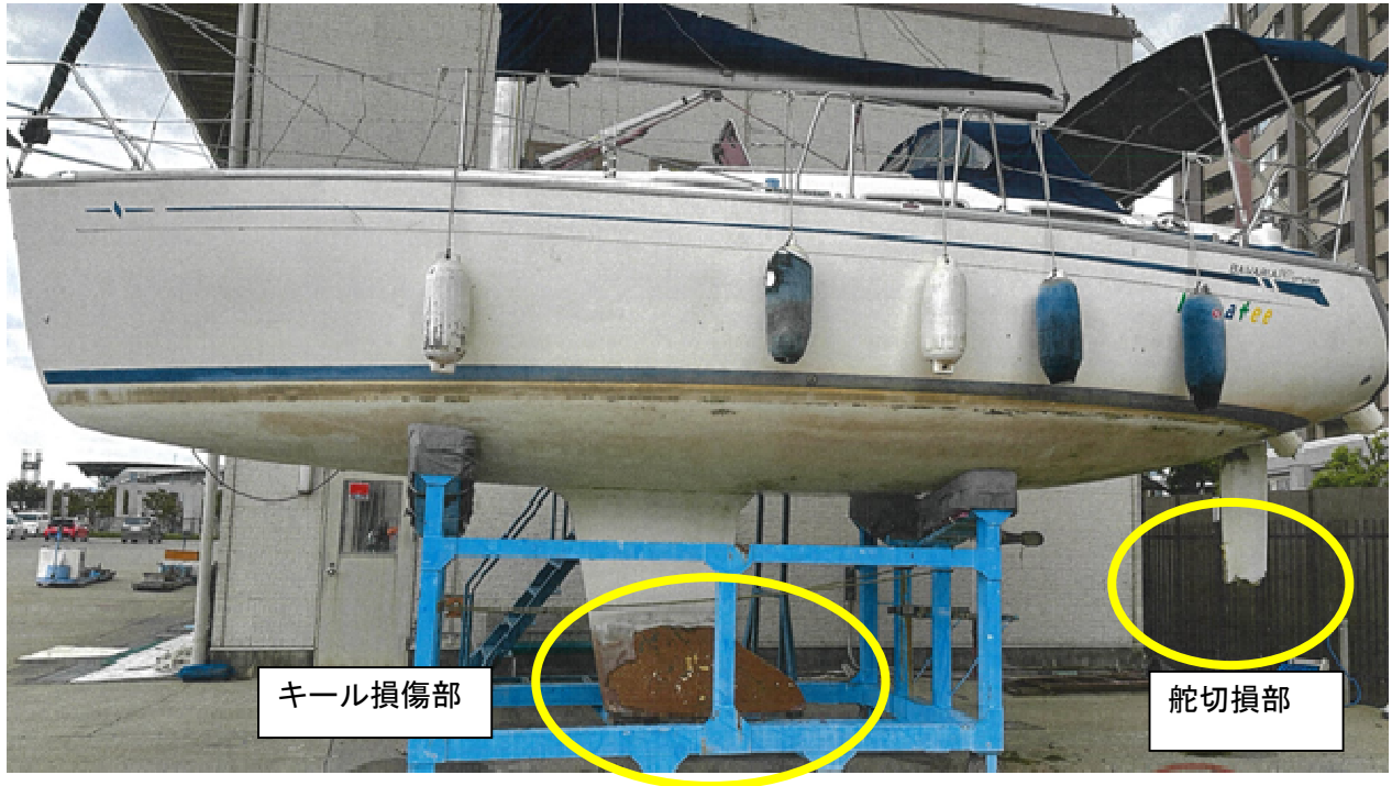
写真1 本船損傷状況
