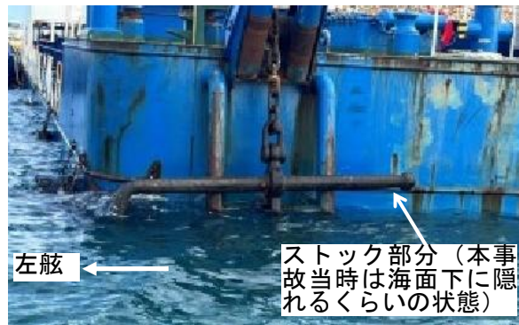
図6 台船錨（左舷側：右舷側と同仕様）の状況
