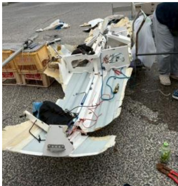
写真1 A船の損傷状況
