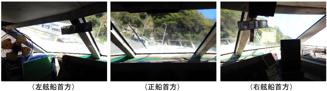
写真3 船長の操船位置からの船首方の見通し状況（本船は写真1の状態）
