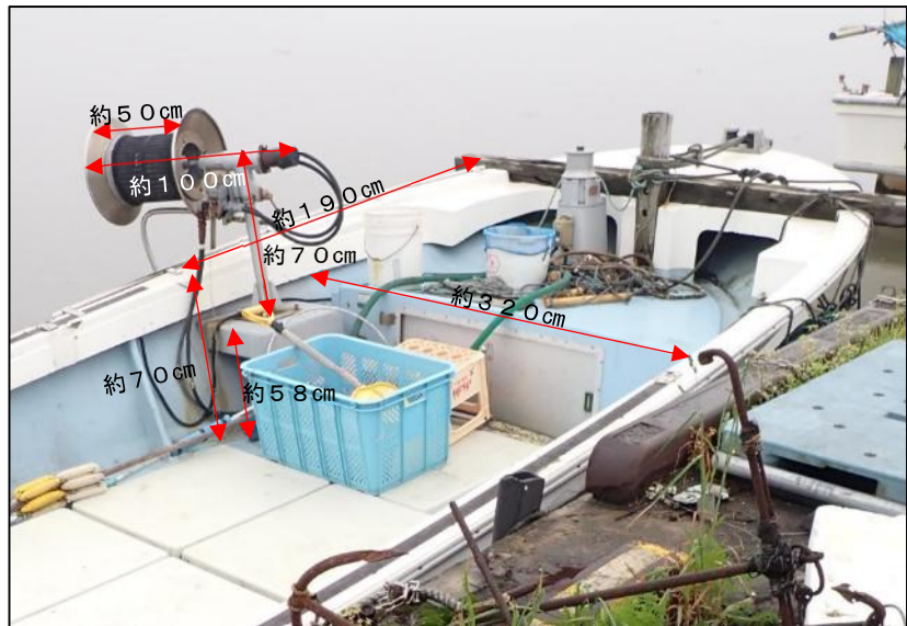
写真3 揚網機付近の状況
