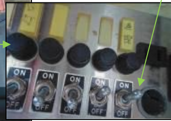
写真4 魚群探知機の電源スイッチの状況（現場調査時に撮影）
