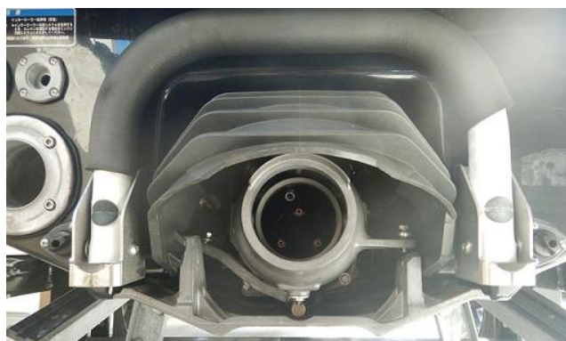
写真6 船尾部のジェットノズル
