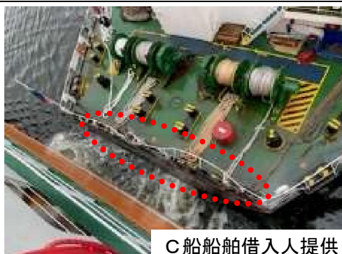
写真2 A 船船尾部損傷状況（本事故時）
