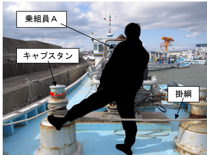
写真2 乗組員Aがキャプスタンと掛網との間に左足を巻き込まれた状況（船首方から撮影）
