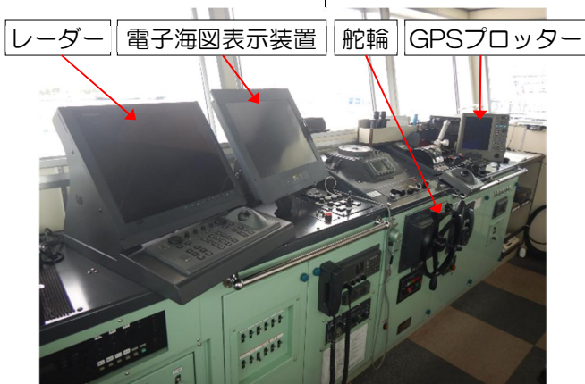
写真1 船橋内の航海計器の配置
