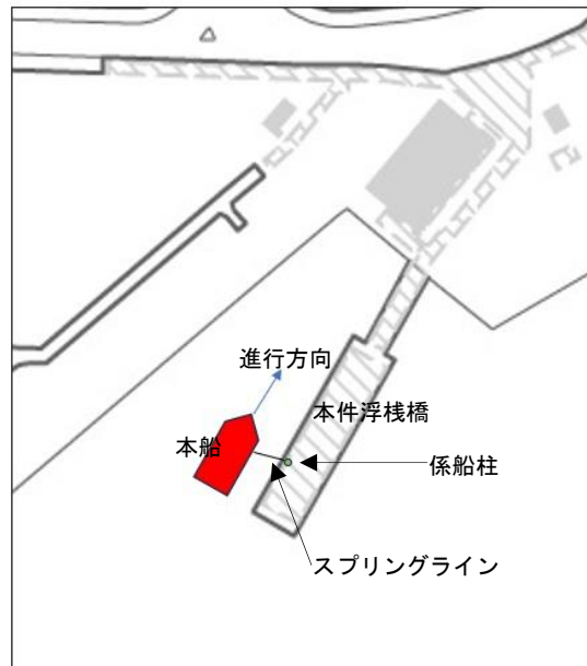
図1 本件浮棧橋にスプリングラインを取った状態
