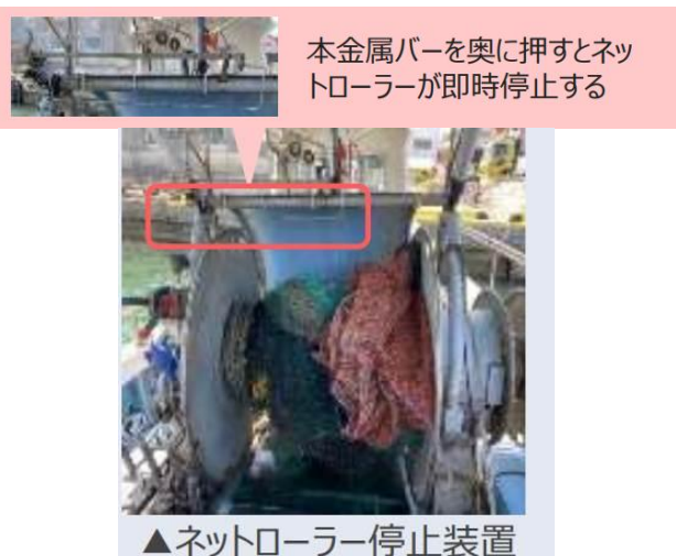
図4 ネットローラー停止装置の概要（香川県漁業協同組合連合会ホームページ）
