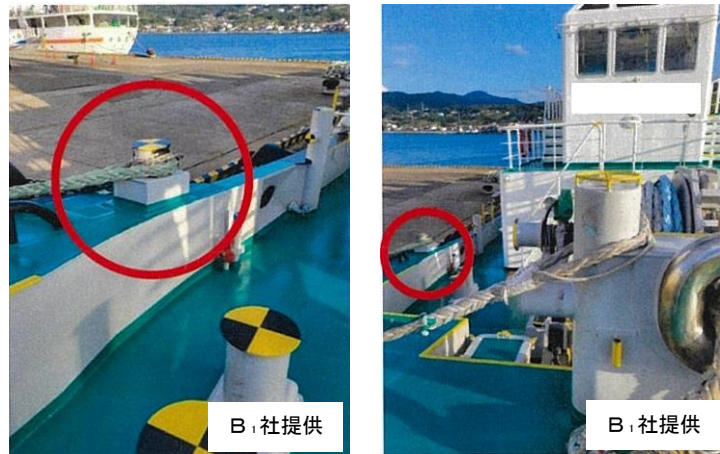
写真1 B船の前部甲板右舷側に設置された本件ビット
