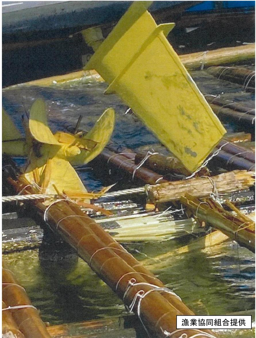
写真1 本船の船尾部がかき筏に乗り揚げている状況
