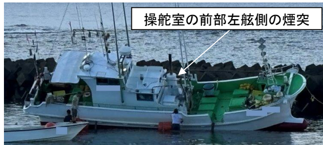
写真1 本船の煙突の配置状況（本事故後の本船、干潮の流れにより船首方向が西方に向けた状態）
