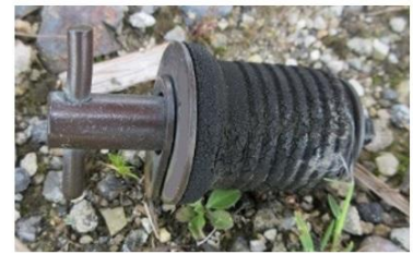
写真5 ドレンプラグ
