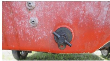
写真4 本件排水口 (ドレンプラグを取り付けた状態)
