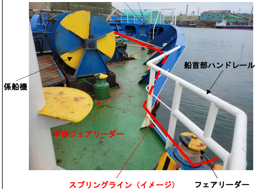
図4 本事故当時のスプリングラインの導き方
