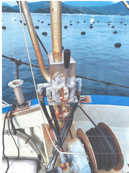
写真5 巻揚げ機の スイッチレバー
