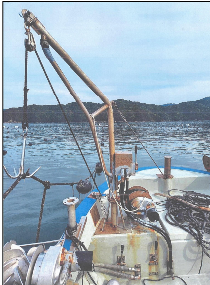
写真1 左舷船首部に設置された巻揚げ機
