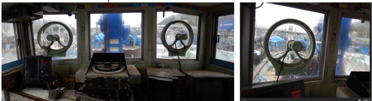
写真6 A船の操舵室内部と操船位置における前方の見通し状況
