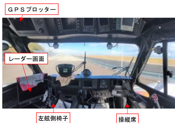
写真5 航海計器類の設置状況
