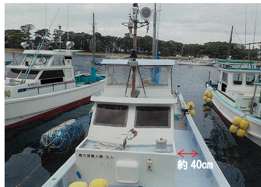
写真5 操舵区画左舷側の通路
