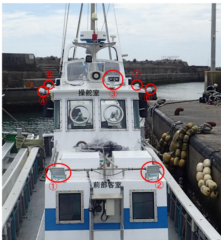
写真4 作業灯の設置状況
