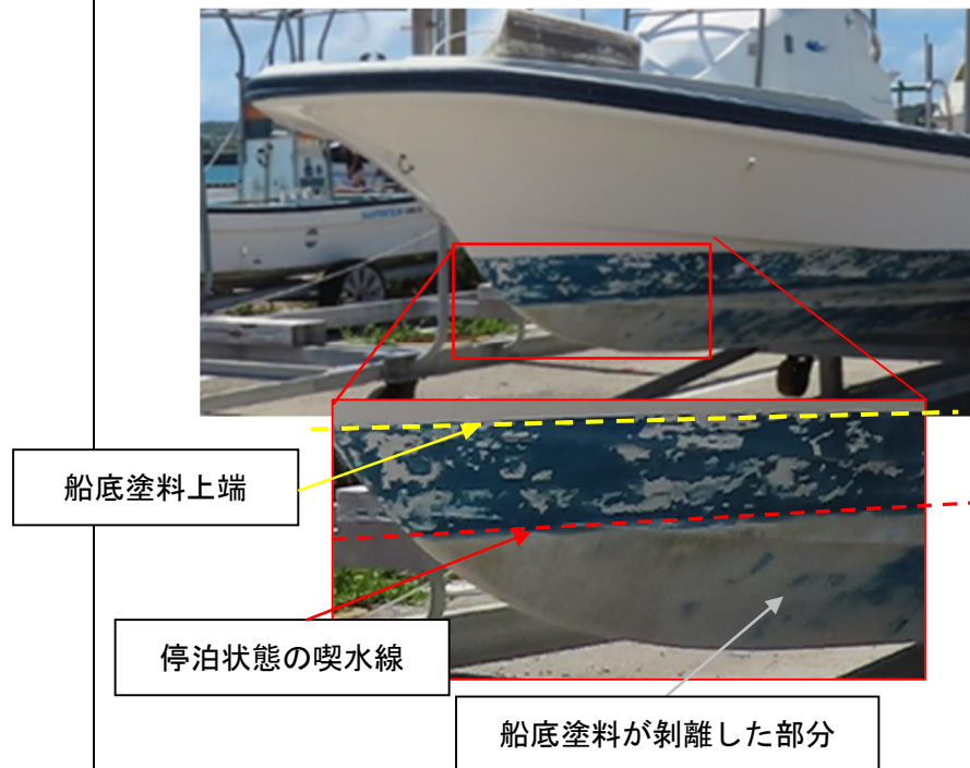
写真5 本船左舷船首部船底付近の状態
