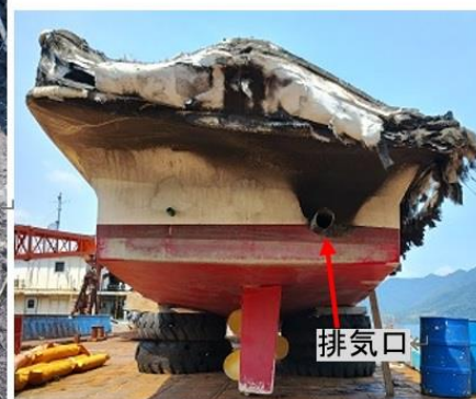
写真6 排気口及び船尾部
