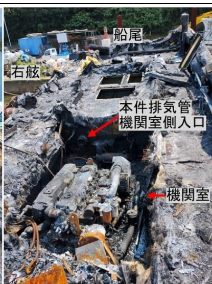
写真5 機関室から船尾方
