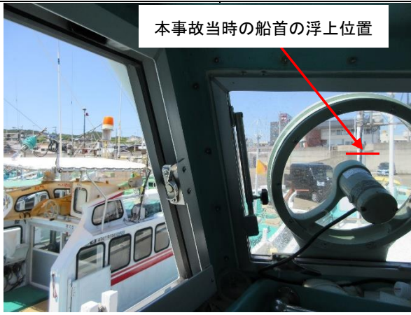
写真3 A船の船首方の見通し状況 (停船時)
