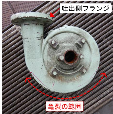
写真4 冷却海水ポンプのケーシング（電動機側側面）
