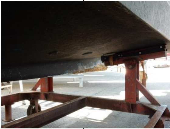
写真1 船底外板及びプロペラの損傷状況
