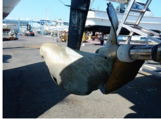
写真1 船底外板及びプロペラの損傷状況
