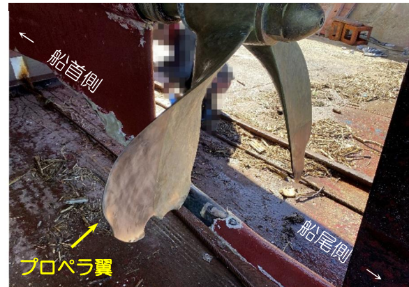
写真3 プロペラ翼の曲損及び欠損状況
