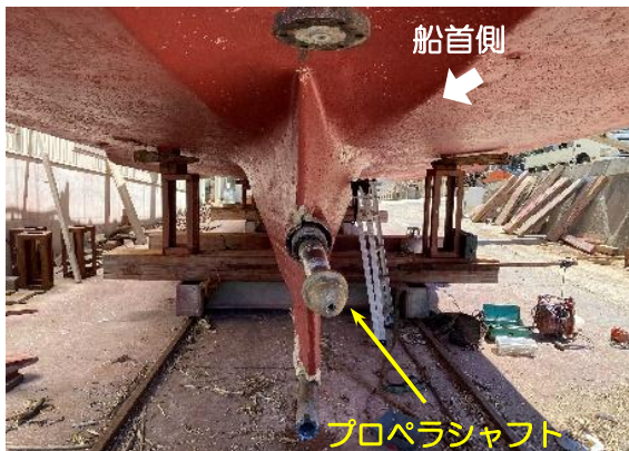
写真2 プロペラシャフトの曲損状況
