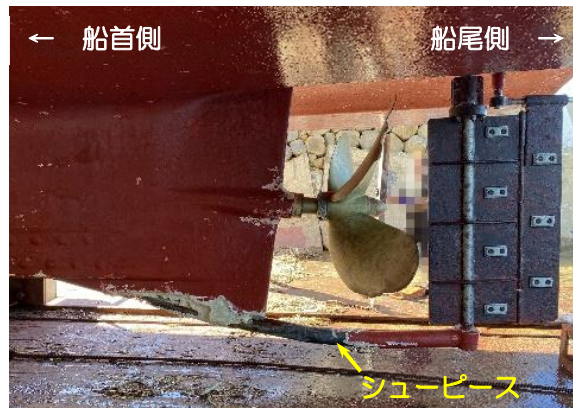
写真1 シューピースの破損状況
