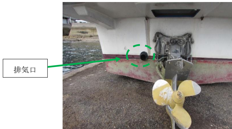
写真7 排気口の状況（本事故後に陸揚げされた際に撮影されたもの）
