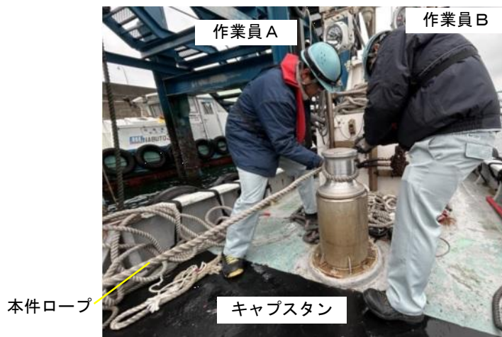
写真 3 作業員 B が本件ロープを右回りでキャプスタンに一周巻いた状況 (再現) (A 社提供)
