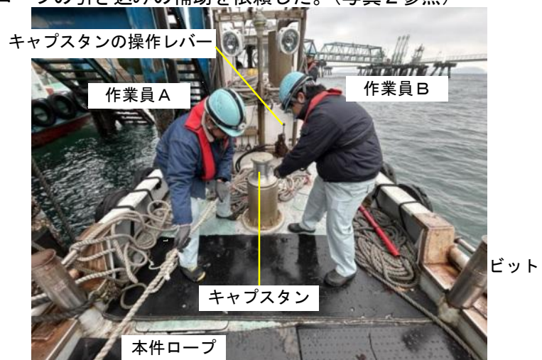
写真2 作業員Aが本件ロープの引き込みを補助している状況（再現）（A社提供）
