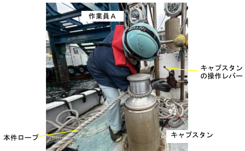
写真 4 作業員 A の右腕がキャプスタンと本件ロープとの間に巻き込まれた状況 (再現) (A 社提供)
