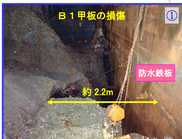
図 1 7 A船の甲板の損傷状況
