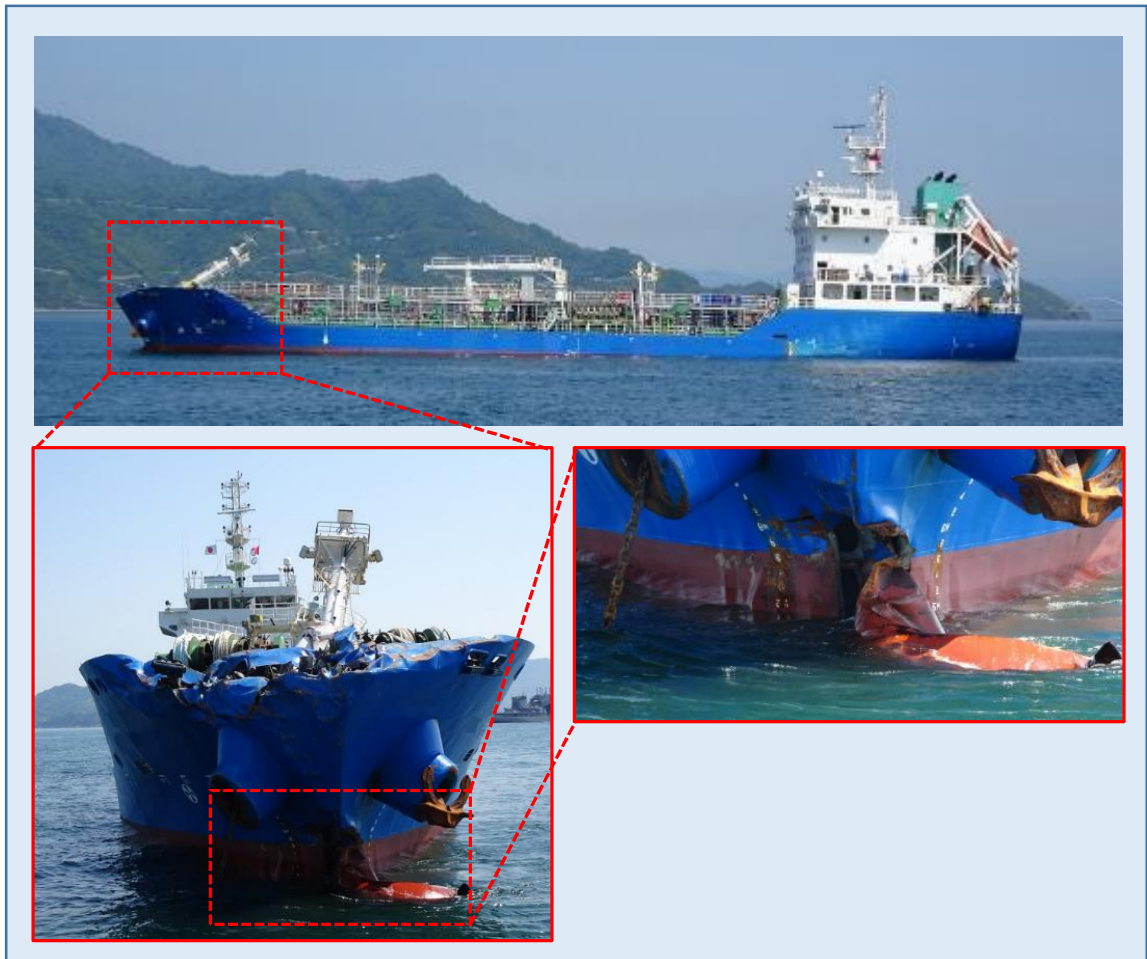
写真3 B船の損傷状況
