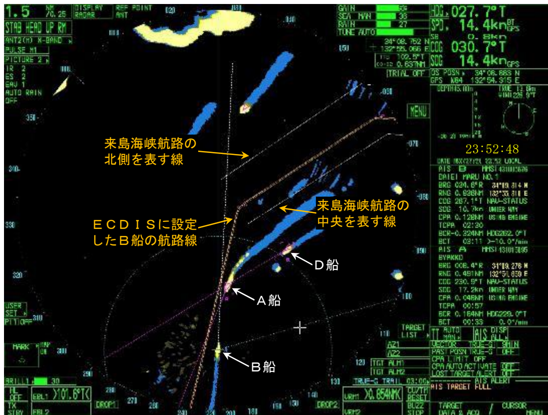
図1 2 B船の2号レーダー映像（23時52分48秒頃）
